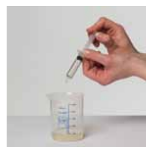
5) Misurazione del filtrato con la siringa graduata in plastica
