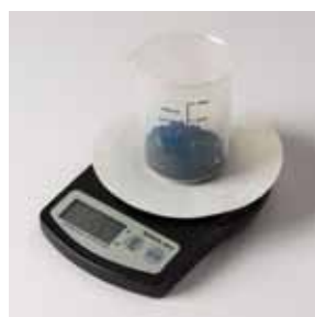
e) Pesatura del campione di terreno per determinare il contenuto di principi nutritivi in mg/kg
