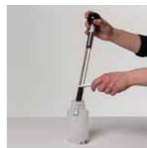
1c) Misurazione del volume con il prelevacampioni graduato (ad es. terreni minerali)
