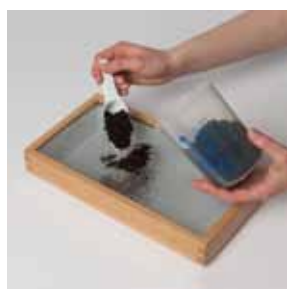
1a) Omogeneizzazione del campione di terreno mediante setacciatura
