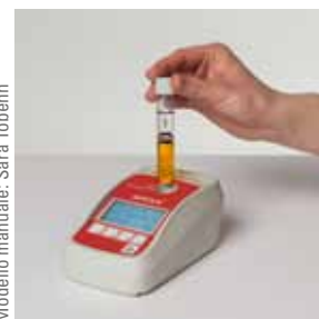
9) Inserimento della cuvetta nell'apparecchio AMOLA® e lettura diretta del valore di misura, ad esempio, in kg/ha (terreni minerali) o in mg/l Substrat (substrato) oppure ...
