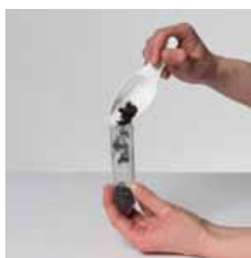
1b) Misurazione del volume del campione con il contenitore graduato (ad es. substrati di coltivazione per giardinaggio)
